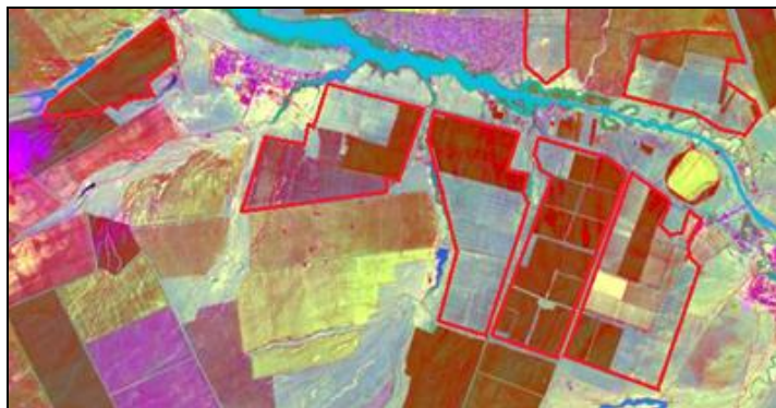
Рис. 3. Композитное изображение оросительных систем вдоль Волго-Донского канала на обработанном алгоритмом «Анализ главных компонент» мультиспектральном изображении со спутника Landsat OLI-8 (01.05.2016.).
