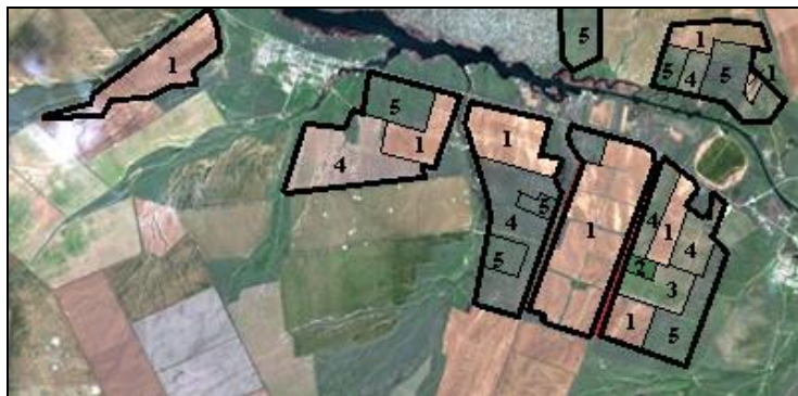
Рис. 2. Визуальное выделение полей с разными сельскохозяйственными культурами и многолетней залежью на космическом RGB-снимке со спутника Landsat OLI-8 (01.05.2016). Условные обозначения: 1 – озимые зерновые, 2 – кормовые травы, 3 – скошенные кормовые травы, 4 – пашня под паром, 5 – многолетняя залежь.
