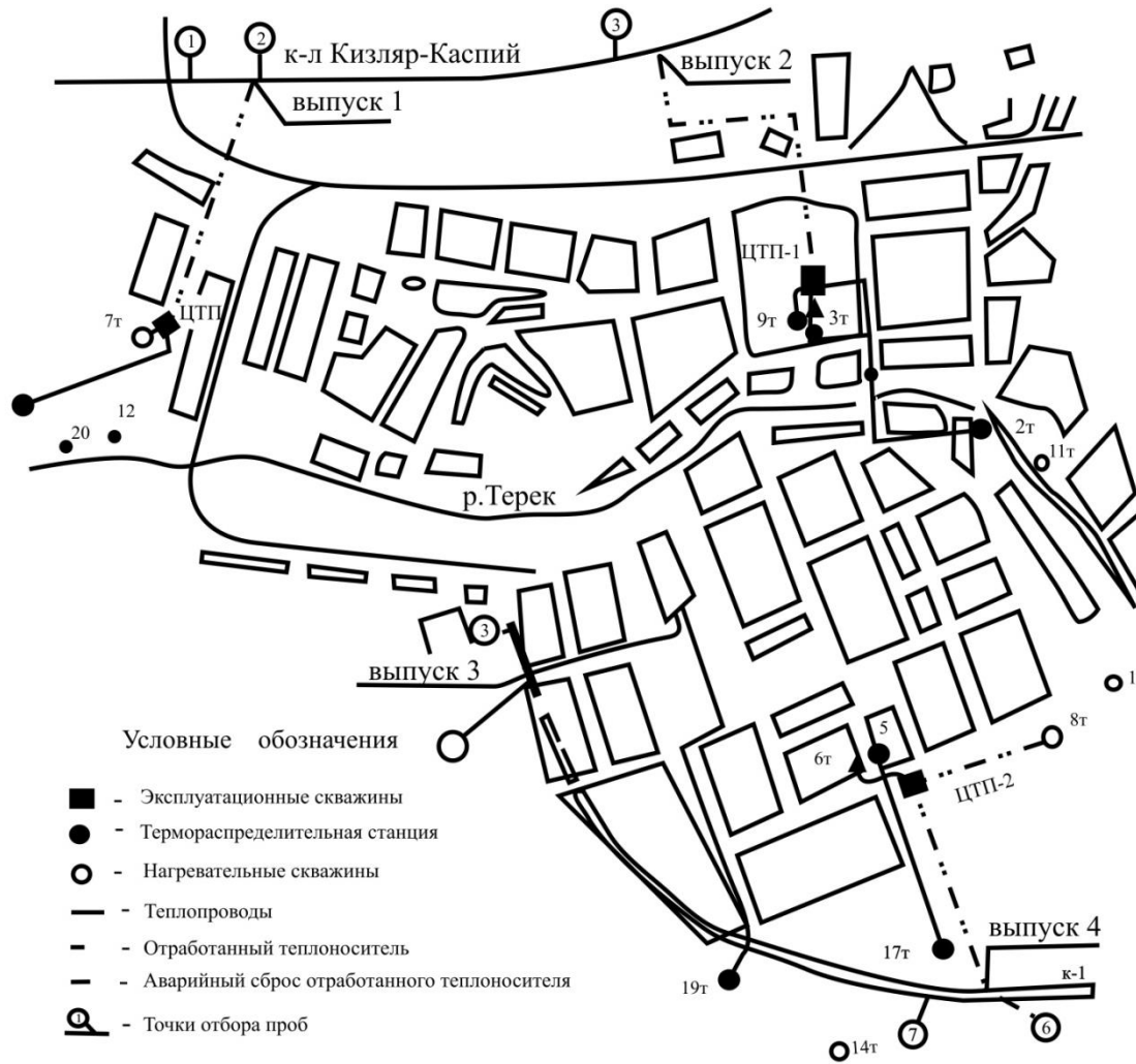
Рис. 3. Схема геотермального теплоснабжения, горячего водоснабжения и сброса отработанной геотермальной воды в г. Кизляре.
